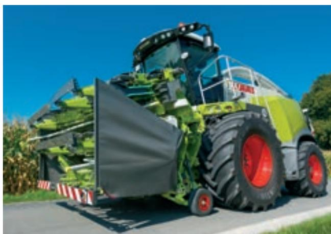
NOUVEAU : système de transport intégré. Lors des déplacements sur route, les roues de transport intégrées à l'ORBIS sont dépliées. Les vérins hydrauliques travaillent également activement. L'amortisseur d'oscillations assure un confort de conduite optimal jusqu'à 40 km/h\*.
