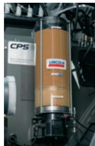
Réservoir de graisse de 16 l
