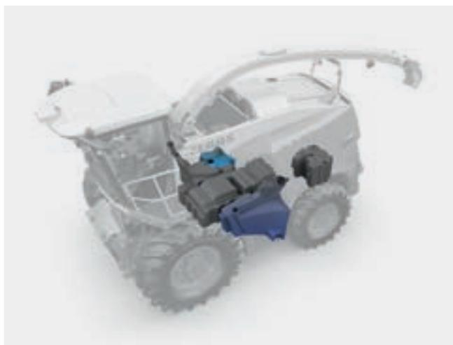
Réservoir de carburant de grande capacité.
