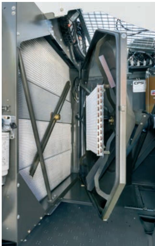
L'air qui arrive des radiateurs traverse le moteur et ressort facilement à l'arrière de la JAGUAR au niveau des sorties d'air de grande dimension. Ainsi, la JAGUAR est parfaitement opérationnelle en toutes circonstances, même à des températures extérieures élevées.
