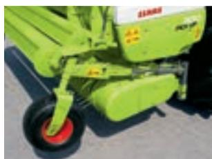
Roues de jauge repliables hydrauliquement
