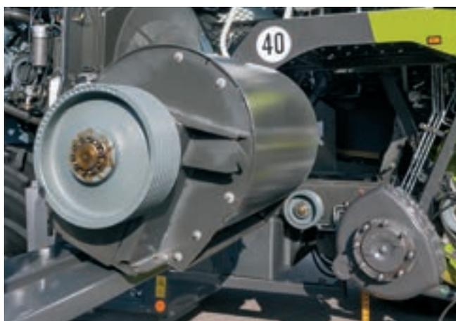
10 mm, ce qui réduit considérablement la consommation de puissance. Si par exemple un fourrage vert sec requiert une puissance d'éjection élevée, l'écartement doit être faible. Ce réglage peut s'effectuer dans le CEBIS même en roulant et être automatisé en mode détournage.
